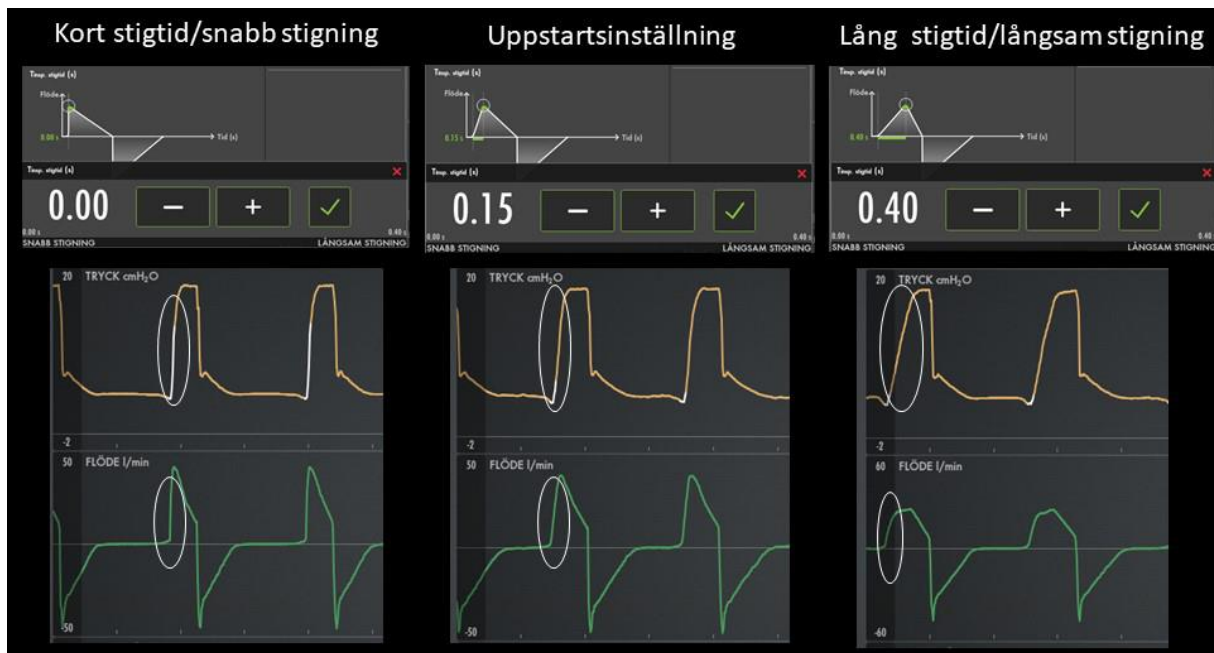
Figur 3, inspiratorisk stigtid. Tryck- och flödeskurvor vid tryckunderstödd ventilation med olika inspiratorisk stigtid. Vid understödd ventilation anges stigtiden i sekunder, vid kontrollerad ventilation i % av hela ventilationscykeln. Orsaken till skillnaden är att vid understödd ventilation är tiden för ventilationscykeln inte känd.
