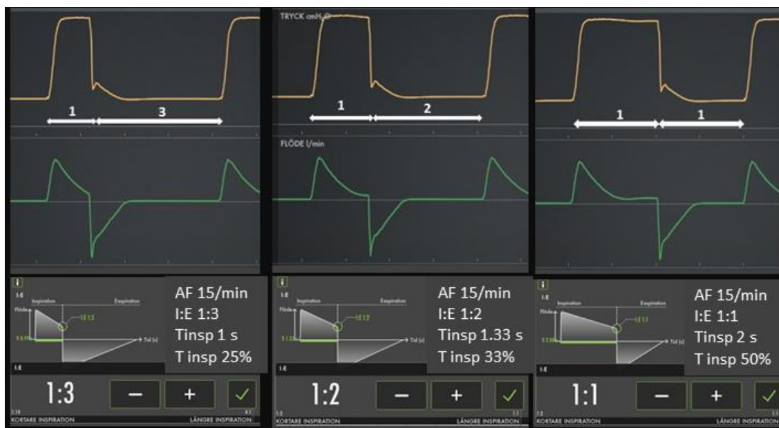
Figur 5, I:E ratio. Tryckkontroll hela tiden med andningsfrekvens 15/min men olika I:E ratio, notera hur I:E ratio kan ses direkt på kurvorna utan att man tar fram inställningarna.
