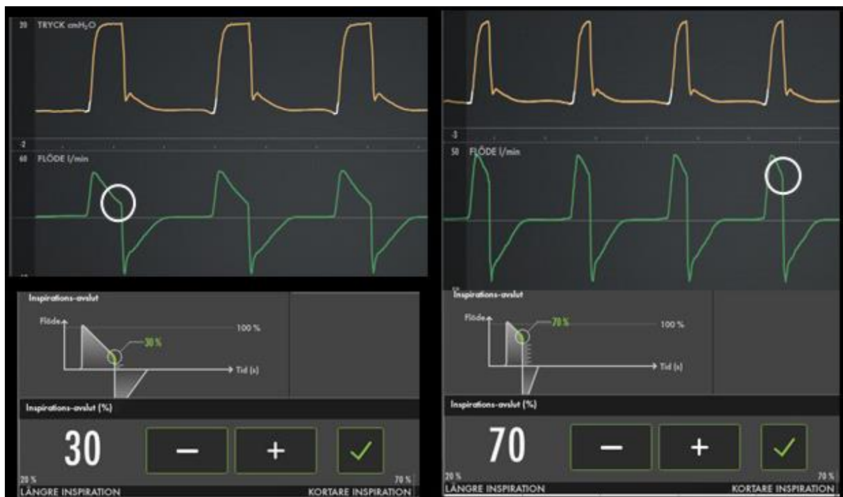
Figur 4, inspirationsavslut. Vid tryckunderstödd ventilation är flödet högst i början av inandningen, ventilatorn växlar till utandningen när flödet reducerats till en viss % av det maximala flödet. Ett högre värde innebär att inspirationstiden blir kortare och att tidalvolymen blir något mindre.
